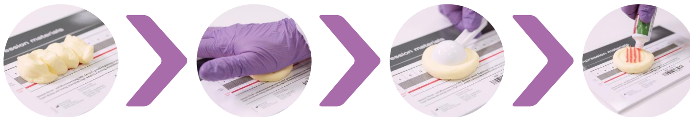
Ryc. 45–48. Zmierzoną ilość materiału należy rozłożyć na płasko za pomocą kłębka kciuka. łyżeczka dozująca służy do odcisnięcia kółka, na które nałożona zostanie pasta aktywacyjna.
