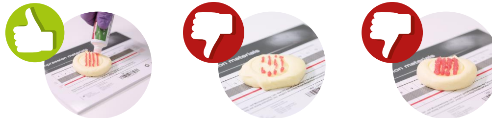
Ryc. 49–51. Prawidłowo nałożone pasma (po lewej). Dla porównania, pasma nałożone nierówno: zbyt cienkie (w środku) lub zbyt grube (po prawej).
