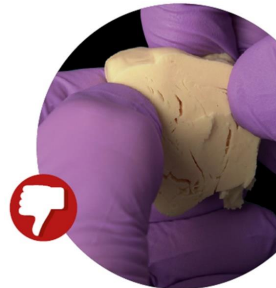
Ryc. 53. Rozwarstwianie się zastygniętego silikonu wynikające z niewystarczająco zmieszanego aktywatora.
